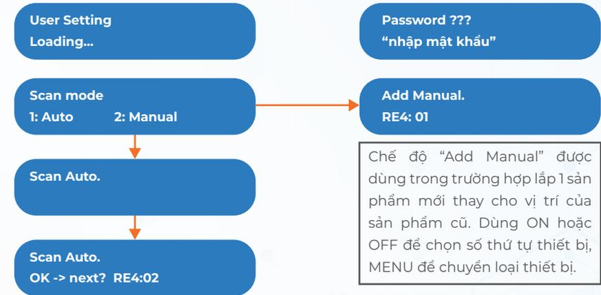
Chế độ “Add Manual” được dùng trong trường hợp lắp 1 sản phẩm mới thay cho vị trí của sản phẩm cũ. Dùng ON hoặc OFF để chọn số thứ tự thiết bị, MENU để chuyển loại thiết bị.
